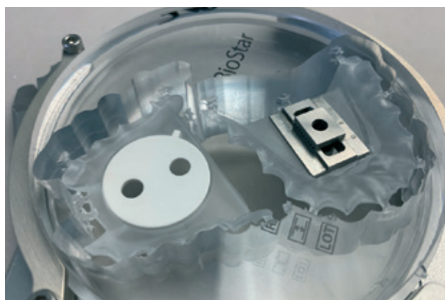
Abb. 3: Gefräste Bissregistrare ersetzen die manuelle Herstellung.
