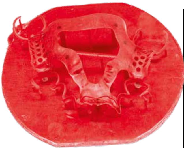
13 Druck aus CAD/ CAST-Material mit minimaler Stützstruktur (Bildquelle: SilaPrint 125/ dentalgrade)
