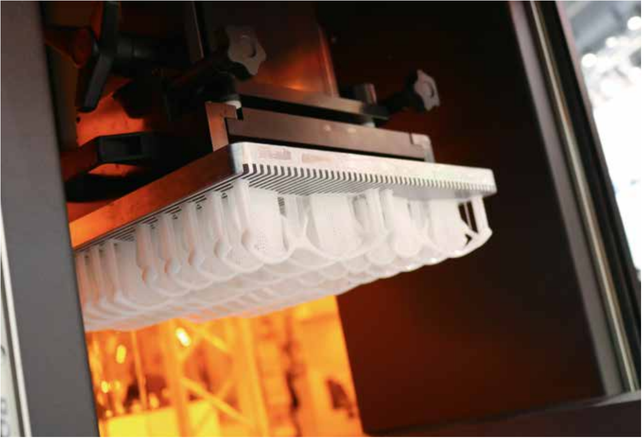
02 Das DLP-Verfahren härtet Photopolymere durch Licht (LED)
